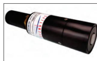
Figure 8. Satlantic PAR sensor
