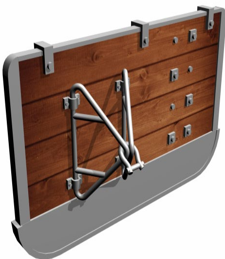
Fig 3.2 Wood trawl door
