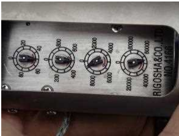
Flow meter (RIGO.No.5571)
